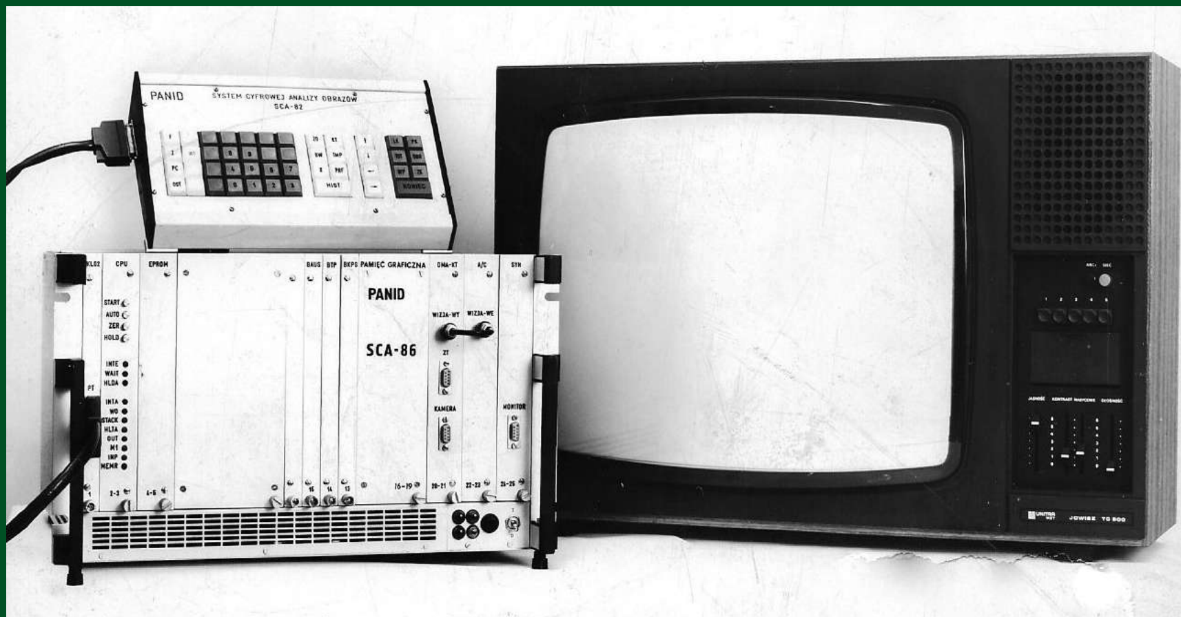
System cyfrowej analizy obrazów termograficznych. (telewizor „Jowisz” pełnił rolę monitora □)
