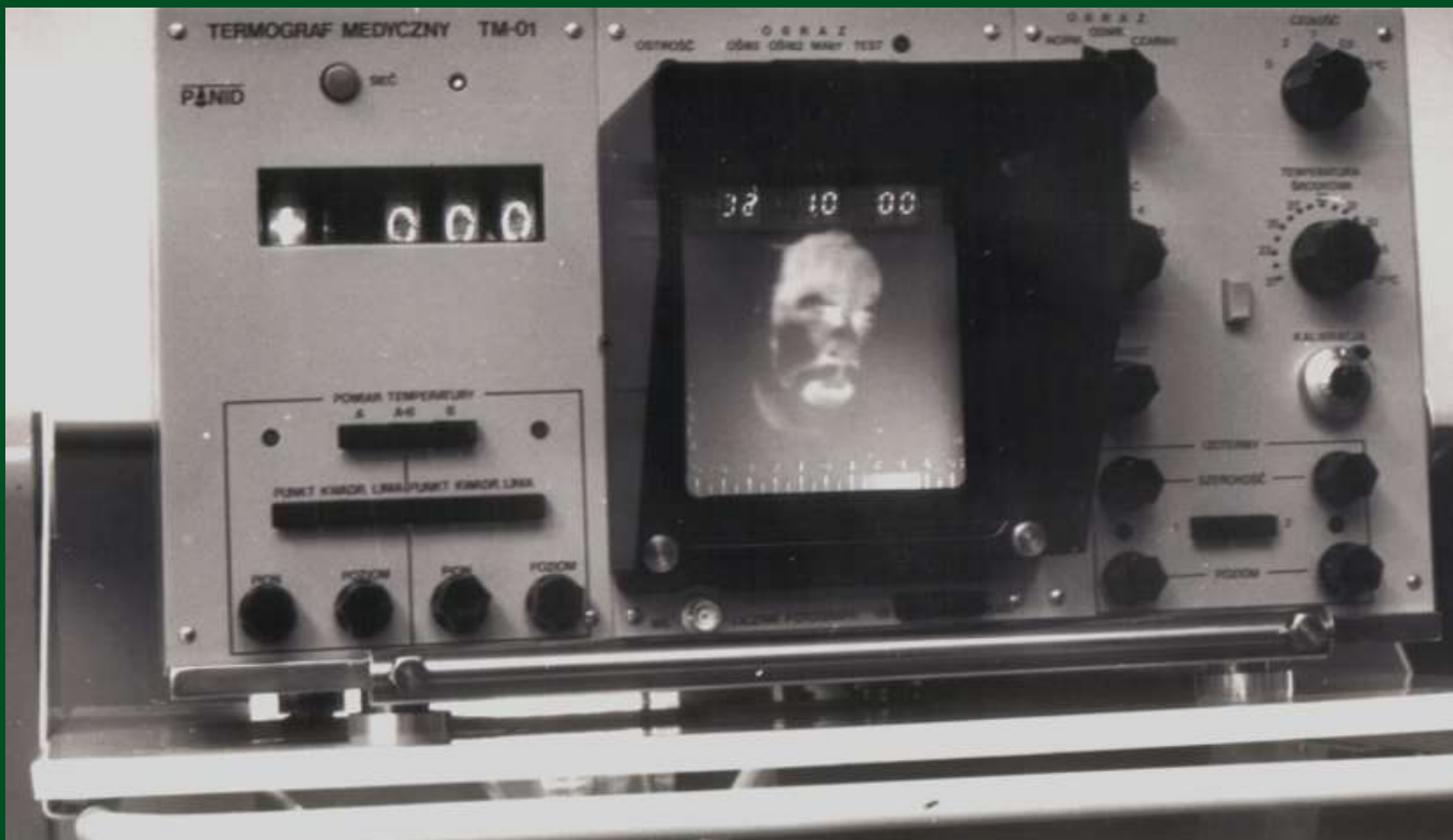
System TM-01; rok 1978. Monitor był wyposażony w cyfrowy indykator pokazujący wartość temperatury w dowolnie wybranym punkcie obrazu termalnego
