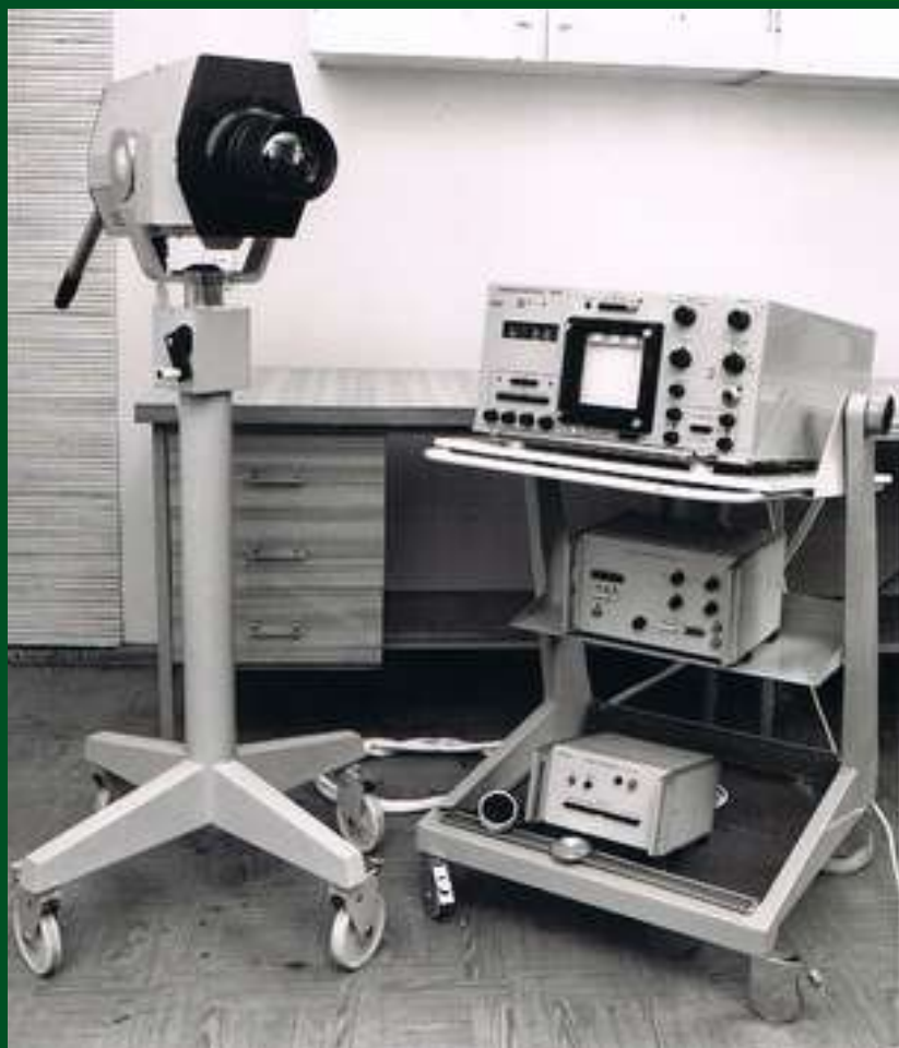
System TM-01; rok 1978. Pierwszy zbudowany w Polsce termograf pracujący w realnej skali czasu
